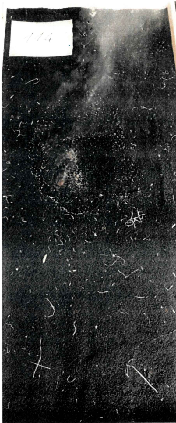
Probekörper 1.1.4 nach den Brandversuchen Specimen 1.1.4 after fire testing
